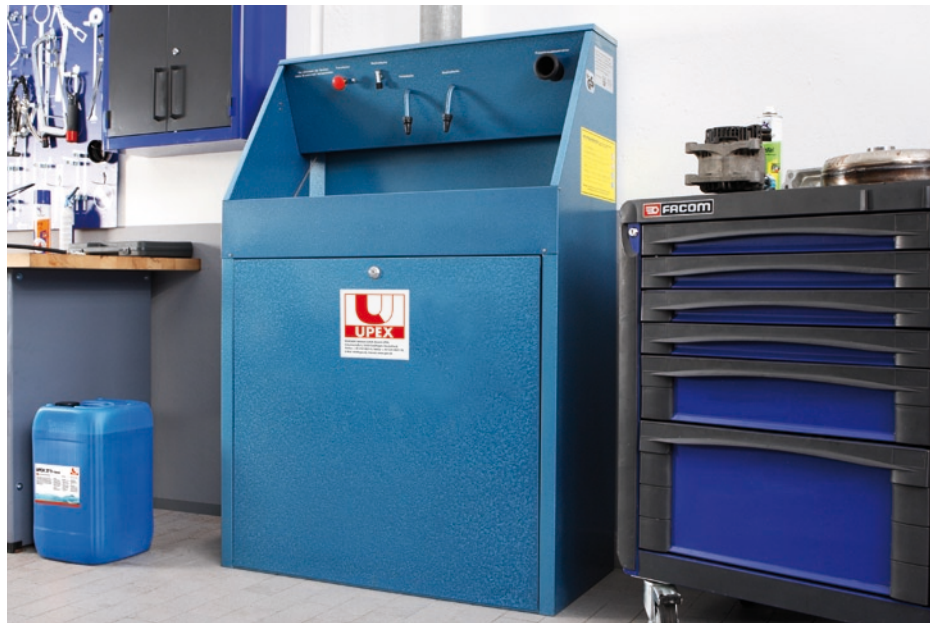
UPEX-Waschkabinett zur Reinigung von Lackierwerkzeugen.
